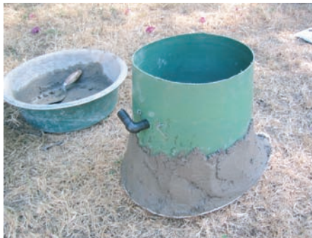
Photo 6-20 : Béton ajouté à mi-hauteur du seau
