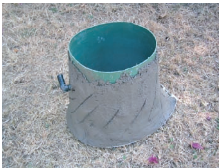
Photo 6-21: Moitié supérieure du seau recouverte de béton
